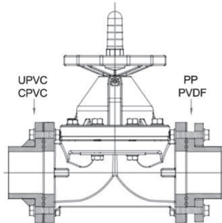
**▲ 注意** 當閥與"突出面"全面法蘭接合或與夾式法蘭連接時，應注意避免鎖力超出造成法蘭「彎曲變形」而漏水。
